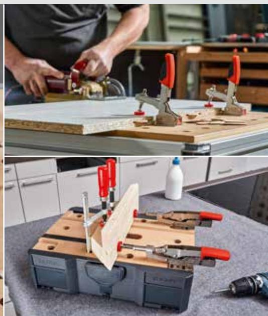
■ Pour l'utilisation des sauterelles à serrage rapide BESSEY sur des tables multifonctions comme par ex. Festool MFT et Sortimo WorkMo avec diamètre de perçage 20 mm et épaisseur de plateau entre 19 mm min et 25 mm max.
